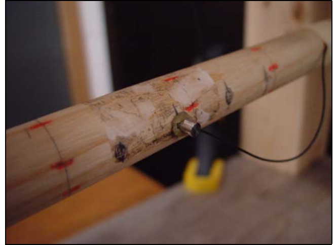
Fig. 5. Bruel & Kjaer 4374 Accelerometer
